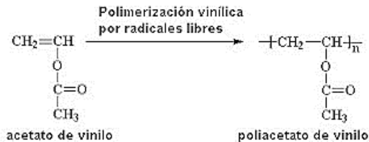
Figura 8. Reacción de polimerización del PAV.
