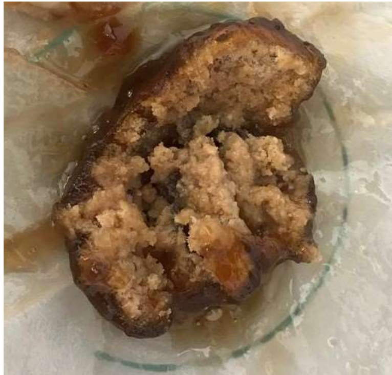
Figura 34. Aspecto de muestras a las 5 h de sifonados en Soxhlet. La muestra se encapsula y por medio de trituración manual se abre capsula para continuar procedimiento de purificación.
