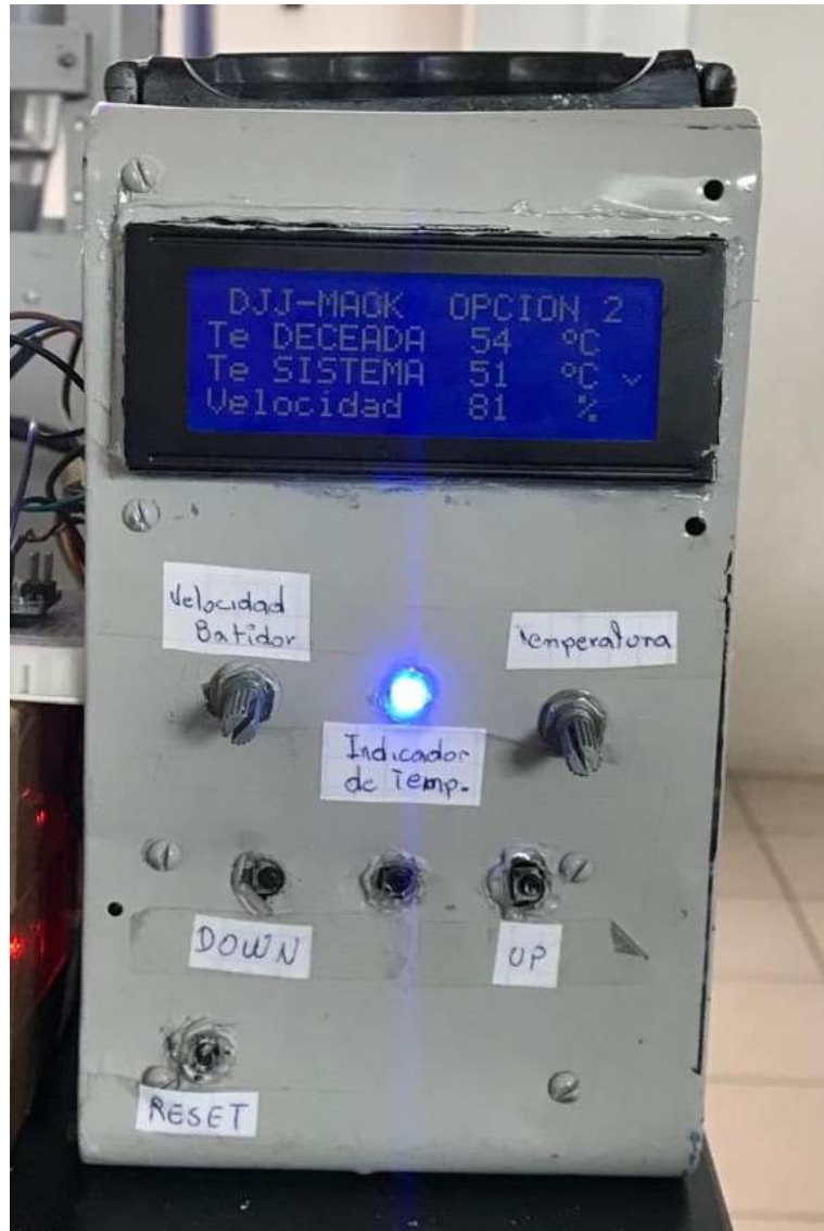
Figura 30. Caja de control de la cámara polimérica automatizada y programada a las condiciones de operación de las corridas.
