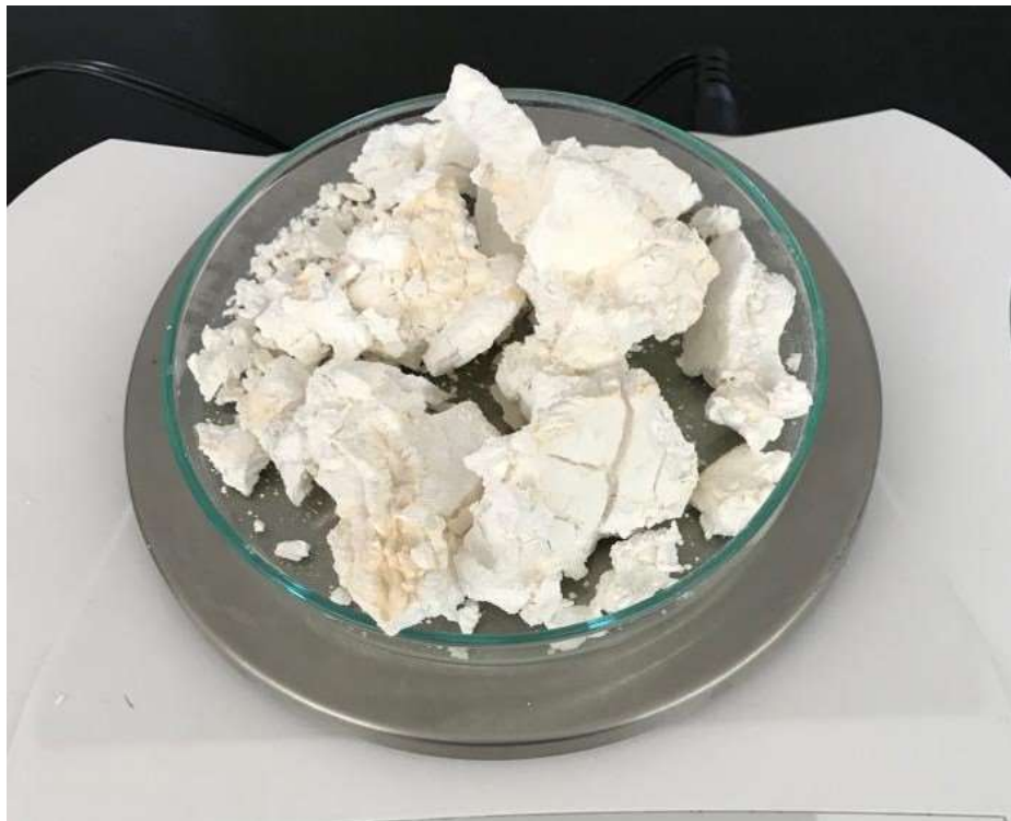
Figura 27. Aspecto tipo piedra del copolímero de síntesis llevado a peso constante.
