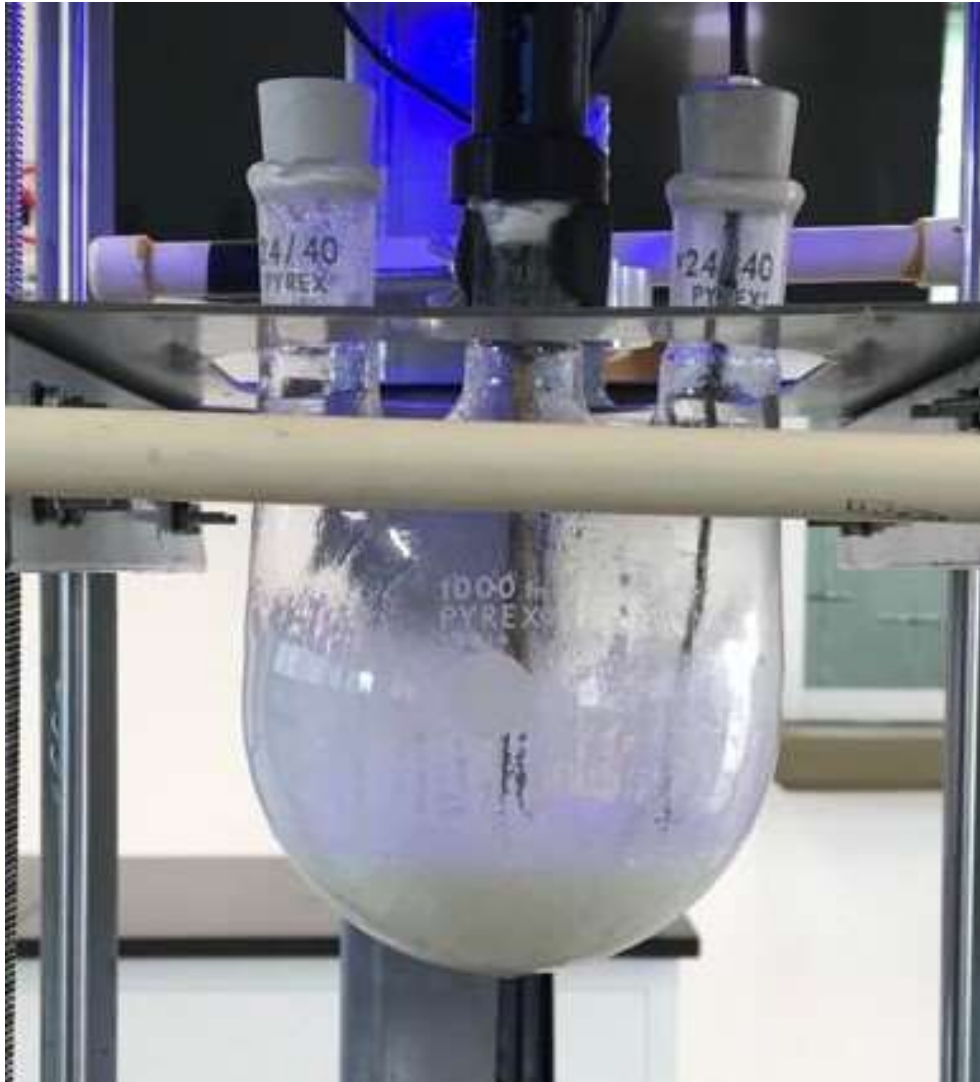
Figura 25. Aspecto del copolímero coagulado (color blanco lechoso) después de 3 h de reacción de síntesis.
