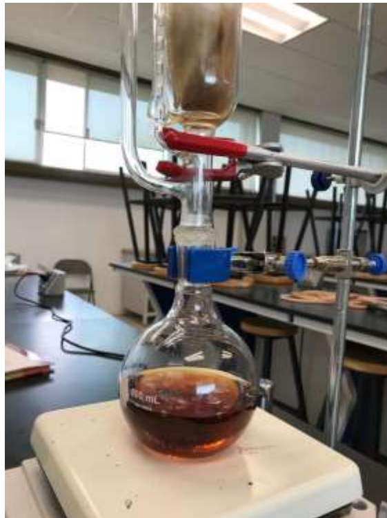
Figura 33. Tonalidad marrón chocolate del solvente del proceso de purificación a las 5 h de sifonados.
