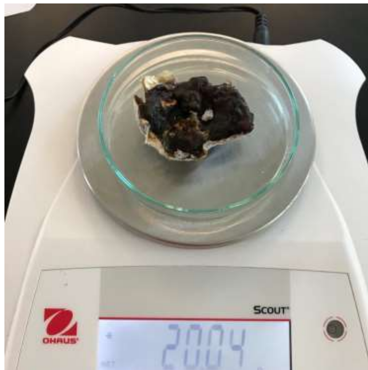
Figura 41. Caracterización gravimétrica (toma de peso) de las muestras resultantes de purificación en Soxhlet.
