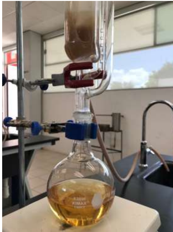
Figura 32. Tonalidad ámbar del solvente del proceso de purificación a las 2 h de sifonados.
