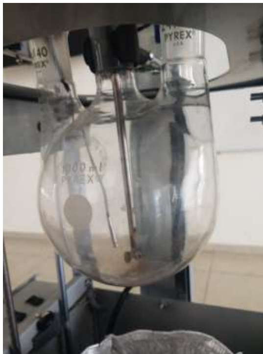
Figura 17. Aspecto del reactor en su parte inferior. Se aprecia el sensor y el agitador de hélice.
