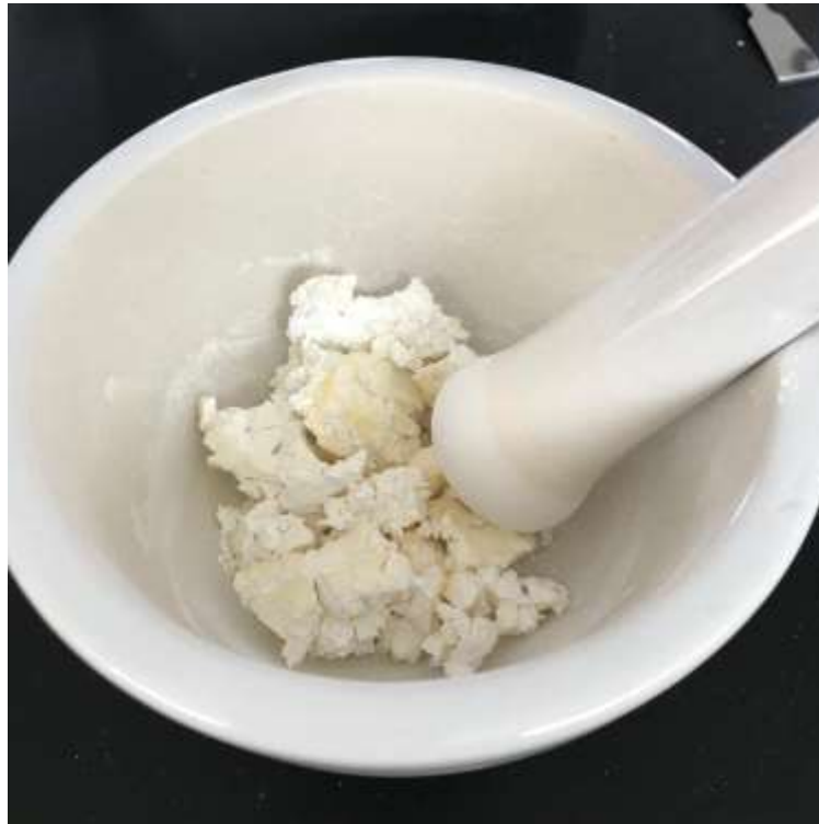
Figura 28. Molienda del copolímero de síntesis para reducción de tamaño de partícula.
